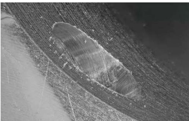
Bohrungsaustritt nach dem Einsatz eines Standard-Bohrers in Alu
