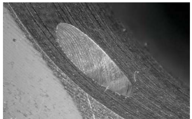
Bohrungsaustritt nach dem Einsatz des ExBurrDrills in Alu
