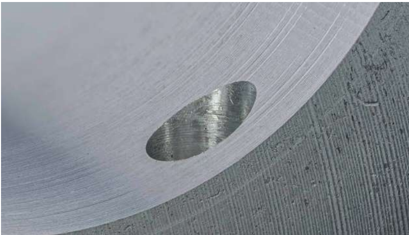
OBN: Achsversetzter Bohrungsaustritt in die Querbohrung in einem Alu-Bauteil. Mit dem ExBurrDrill ist selbst bei dieser Bearbeitung fast kein Grat zu messen.
