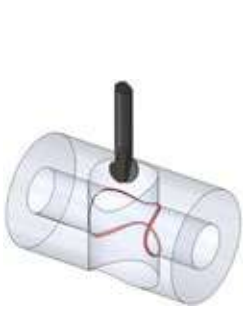
UNTERBROCHENE BOHRUNG ACHSVERSETZT Querbohrung > Hauptbohrung
