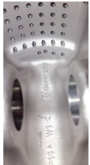
Bohrungsaustritt an Schräge
