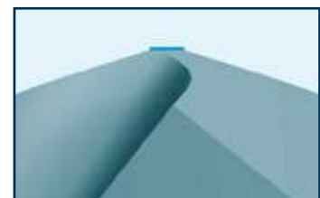
KLASSISCHER VHM-BOHRER Keine Zentrierkräfte im Bereich der Querschnitte
