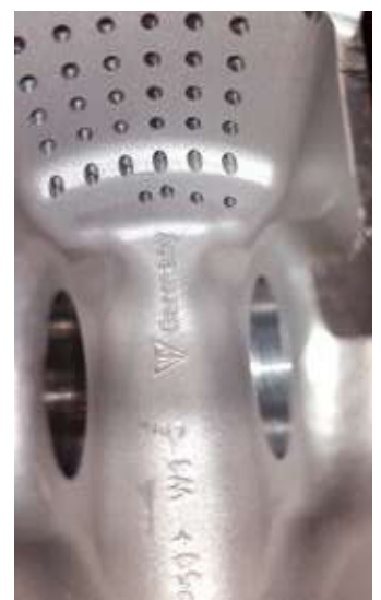
Bohrungsaustritt an Schräge
