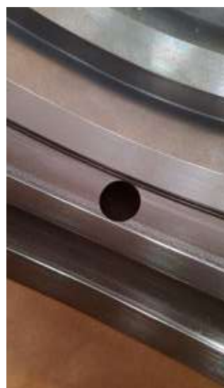
Bohrungsaustritt im Radius
