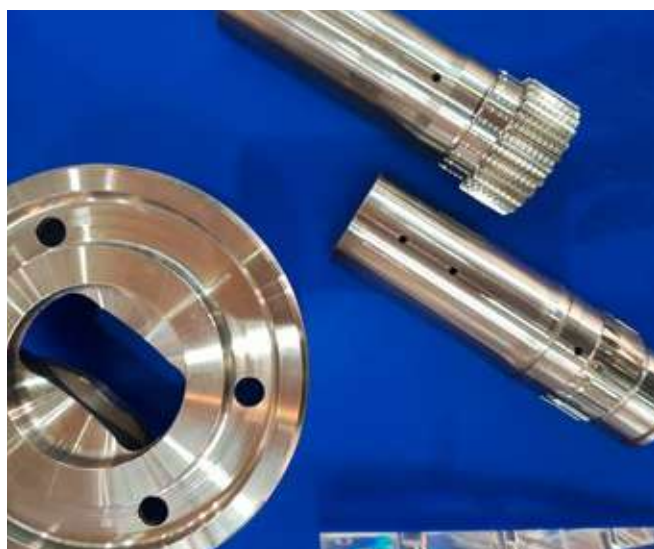
Bohrungsaustritt an einer Welle
